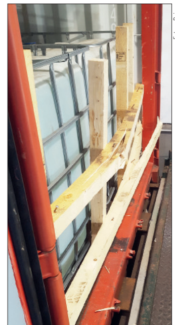
Unzureichende Paltung zur Türseite in einem mit IBC beladenen Container
